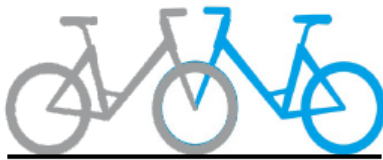
Figure 7 : Principe de disposition des vélos avec recouvrement des roues avant
